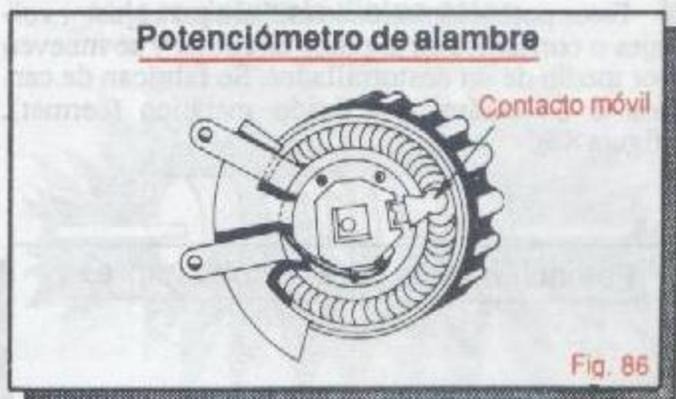
Un potenciómetro puede ser lineal, logarítmico o antilogarítmico. Un potenciómetro lineal es aquel cuya variación es constante durante el giro del eje o cursor. Por ejemplo, si se gira  $15^\circ$  la resistencia aumenta  $1.000 \Omega$ , y si se gira  $30^\circ$  la resistencia aumenta  $2.000 \Omega$ .
