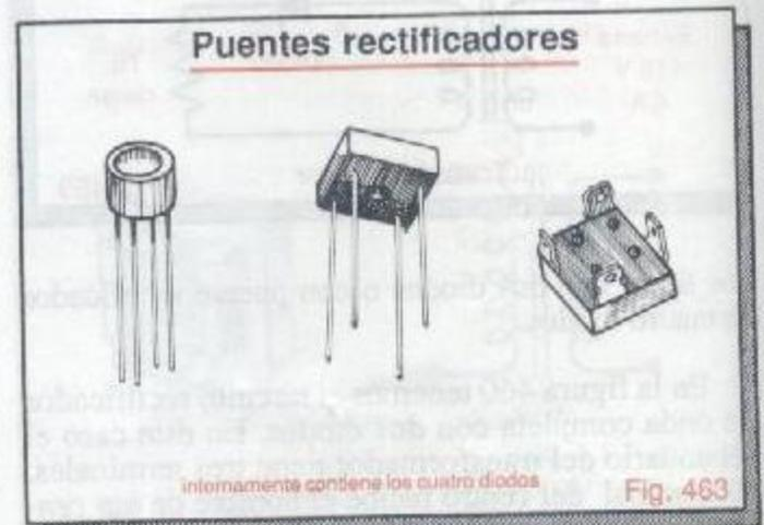
Para los casos de rectificadores de onda completa con dos diodos, con cuatro diodos o con puente rectificador éstos deben estar de acuerdo al voltaje y a la corriente que se desean rectificar.
