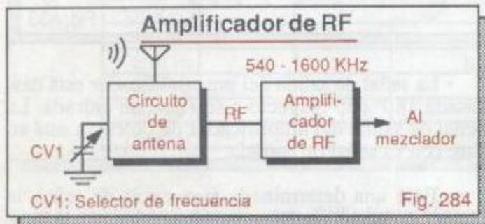
El amplificador de RF debe tener un ancho de banda apropiado para seleccionar la portadora y sus bandas laterales y rechazar al mismo tiempo las señales provenientes de emisoras adyacentes. En el caso del radio AM CEKIT, este ancho de banda es de 9 KHz, aproximadamente.
