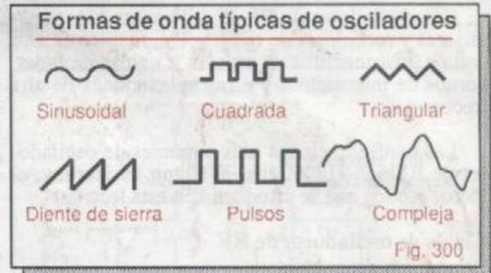
Los circuitos que producen señales no sinusoidales se denominan comúnmente *osciladores de relajación*. Las formas de onda no sinusoidales, generadas por los osciladores de relajación, son ricas en armónicos de diversos órdenes, es decir, contienen frecuencias que son múltiplos enteros de la frecuencia fundamental de oscilación.
