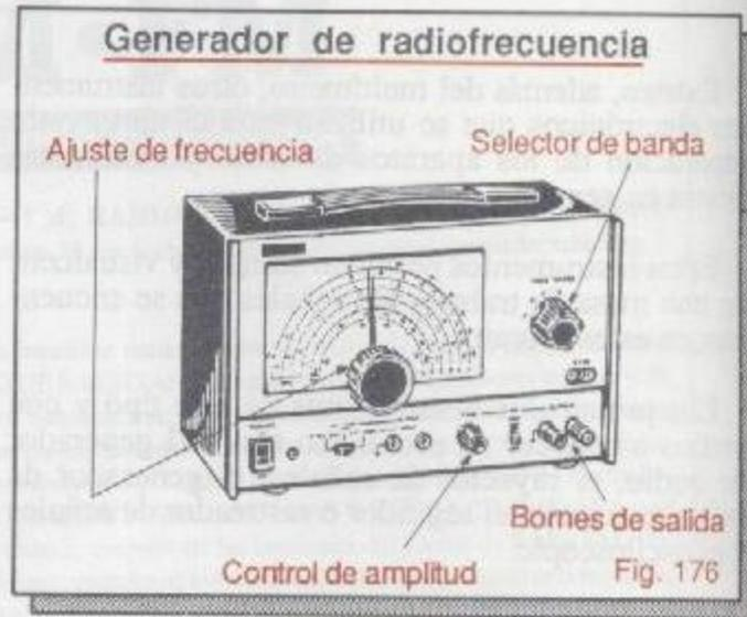
Los principales controles de un generador de RF son: El selector de banda, que selecciona una banda o rango de frecuencias para la señal de salida, la perilla selectora de frecuencia dentro de la banda seleccionada y un control de amplitud que determina el tamaño de la señal que se va a aplicar al circuito.
