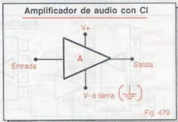
Además de estos pines tiene unos terminales auxiliares para la conexión de algunos componentes externos que se utilizan para determinar las características de la etapa. El número de estos terminales varía según el modelo o referencia del circuito integrado y depende de su complejidad interna.
