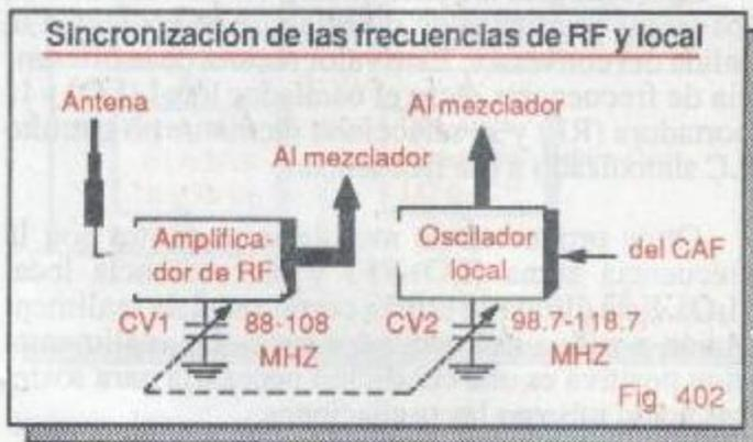
El condensador CV1 controla la frecuencia de resonancia del circuito de sintonía del amplificador de RF y CV2 la del circuito determinador de frecuencia del oscilador local. De este modo, al variar la primera, lo hace también la segunda, en la misma cantidad y en la misma dirección.
