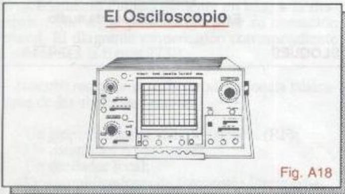
Los osciloscopios comparan señales eléctricas contra el tiempo, produciendo en la pantalla de un tubo de rayos catódicos (TRC) la imagen gráfica, o forma de onda, del voltaje aplicado a su entrada. Sobre esta imagen se realizan medidas de voltaje y de tiempo y se analizan fenómenos como distorsiones, ruidos, interferencias, etc.
