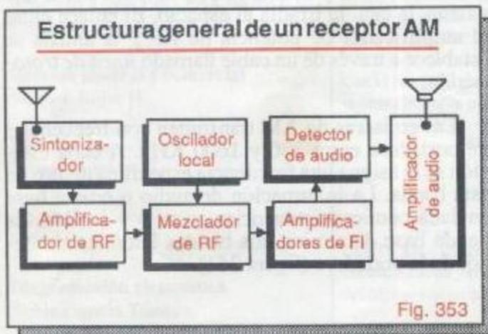
A la antena llegan señales provenientes de un gran número de estaciones. El sintonizador selecciona una en particular, la amplifica y la suministra a un mezclador o convertor de frecuencia. En el mezclador, la señal modulada de RF se combina o *heterodina* con una señal de alta frecuencia proveniente de un oscilador local.
