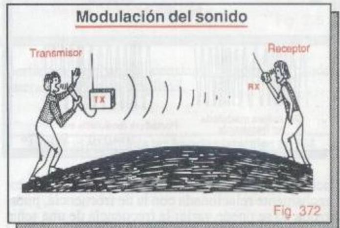
Mediante el proceso de modulación modificamos cualquier característica de la portadora de acuerdo a la información de audio que deseamos transmitir. Las características de una portadora susceptibles de modular son su amplitud, su frecuencia y su fase (figura 373).
