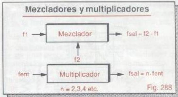
En el caso del radio AM CEKIT, el dispositivo activo usado como amplificador de RF (Q1), actúa también como mezclador, combinando la frecuencia de la señal de antena con la del oscilador local, para producir una señal que tiene una frecuencia de 455 KHz (FI).
