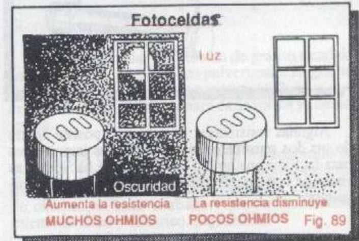
Una fotocelda presenta un bajo valor de su resistencia ante la presencia de luz, y un alto valor de resistencia ante la ausencia de luz.
