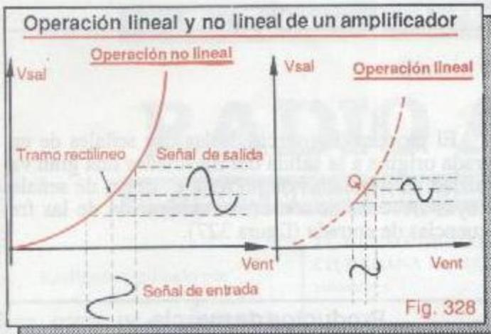
La posición del punto de trabajo de un mezclador la controla la señal proveniente del oscilador local. Esta señal es relativamente grande comparada con la señal de entrada. Sin señal de control, el circuito opera como un amplificador lineal, es decir, de clase A.
