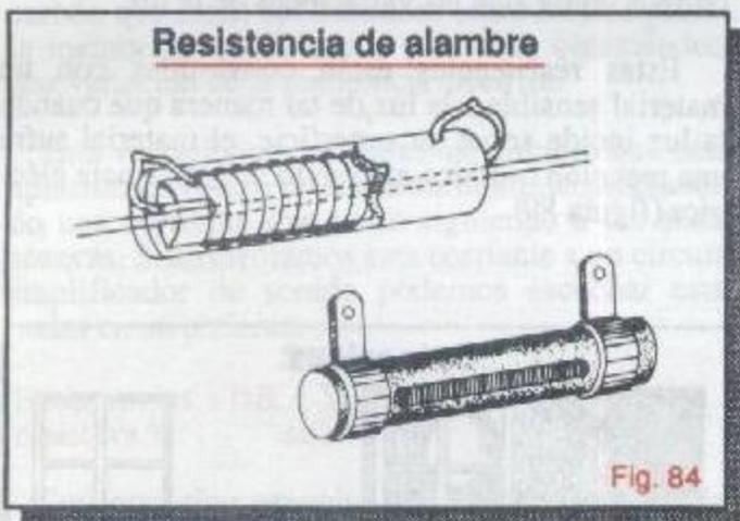
Algunas resistencias de este tipo poseen aparte de sus dos terminales, otros contactos intermedios para facilitar un cambio en el ohmiaje, haciendo las veces de varias resistencias en un sólo cuerpo o envoltura.
